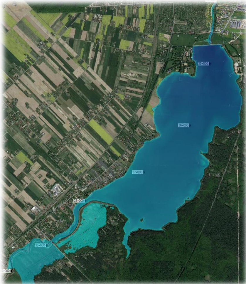
Napełnienie przy dopływie Q_{doz} przy normalnym poziomie piętrzenia
