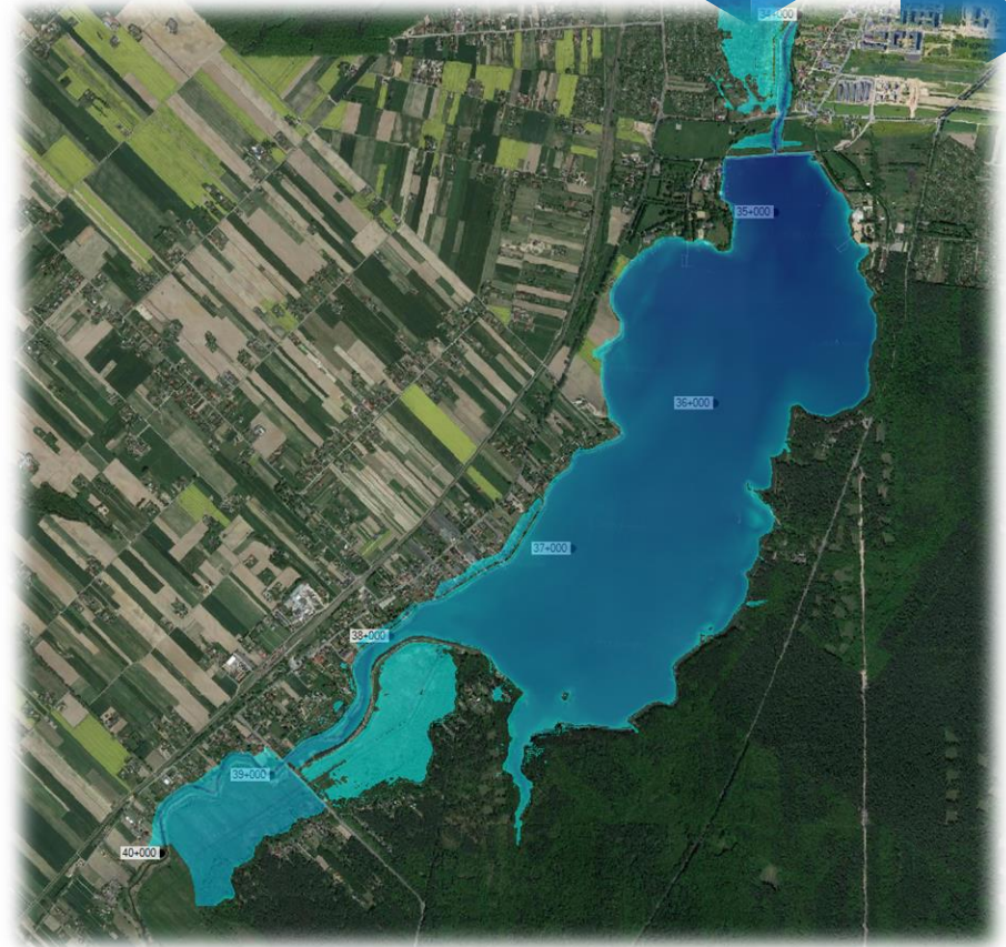
Napełnienie przy przepływie Q_{1\%} + otwarte urządzenia upustowe
